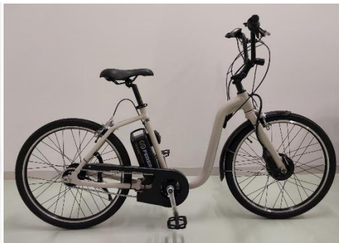
再生电动助力系统“FEREMO™” 及试制车辆
