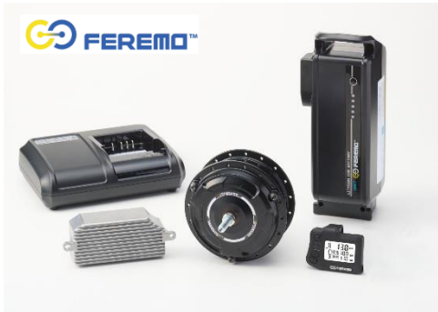
再生电动助力系统“FEREMO™” 及试制车辆
