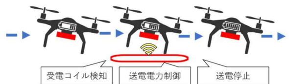
図2 送電側電力制御
