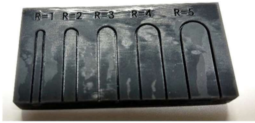
図 4 曲げ半径再現治具
