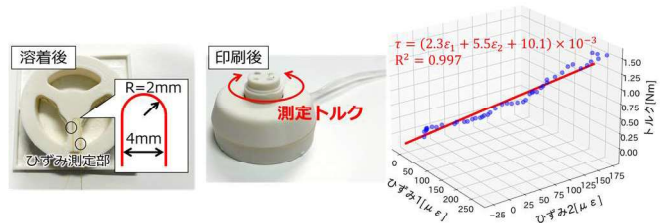
図 7 トルクセンサの具現化
