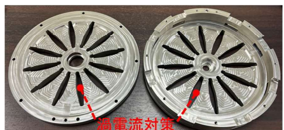
図 6 渦電流損対策を施した 2 号機のモータケースの試作品
