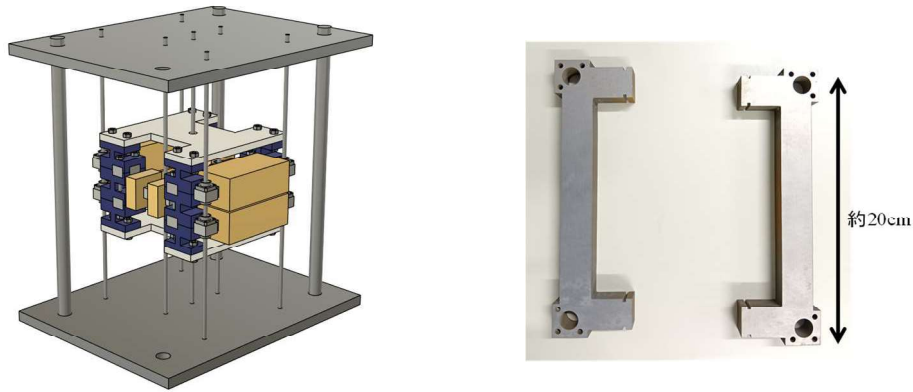
図 5 改良発電機の外観
