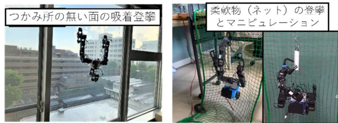
【展望 2】吸盤併用グリップを応用した多様な登攀とマニピュレーション
