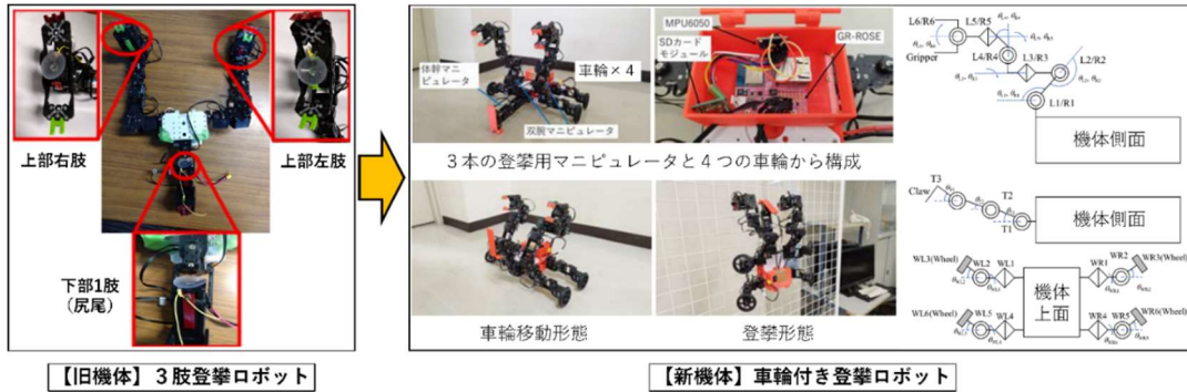
図 1 3肢登攀ロボットから車輪付き登攀ロボットへの機体改良
