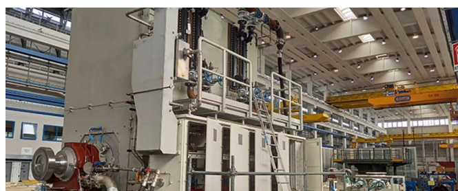
ニデック・コンバージョン事業の出力45メガワット高スピードモータ
