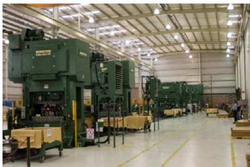
▲高速精密プレス機器（荷重200トン）
