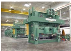
高速精密プレス機器(荷重1650トン)
