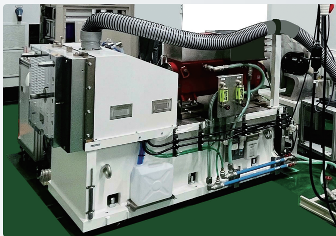
● システム構成例：EVモータ用1軸テストベンチ (20,000rpm仕様)
