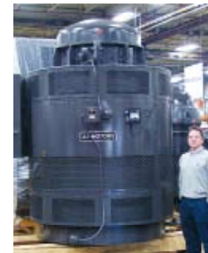
高推力垂直モータ(5000馬力) 用途：深井戸用ポンプ
