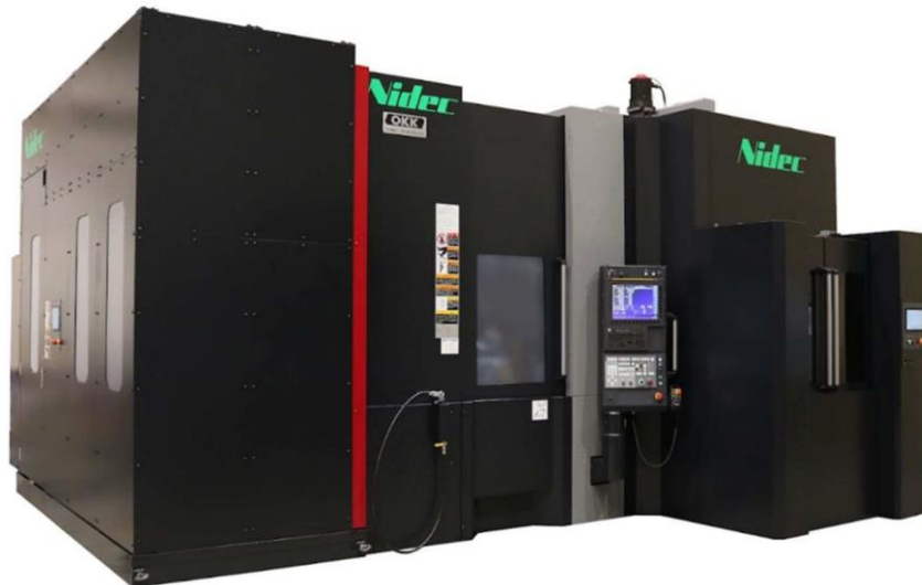
立型5軸マシニングセンタVB-X650に、 マトリックスマガジンと立体パレットストッカを取り付けたオートメーションパッケージ
