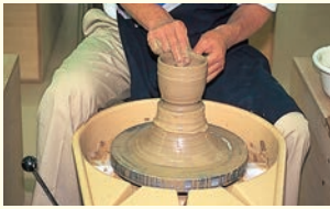
⑬口縁をなめし皮で、飲みやすい形に整えます。
