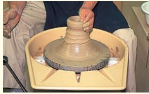
⑥ある程度まで粘土の高さを上げ、親指で中央に穴をあけます。
