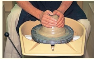
③水をつけ、粘土を押さえたり、引きのばしたりしながら中心を決めます。
