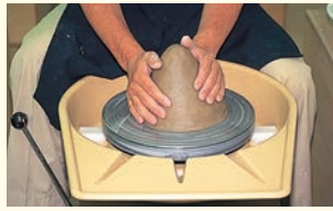
②粘土の玉を中心に置いて押さえつけます。
