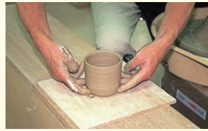
⑮両手の人さし指と中指で持ち、ろくろからおろして完了です。
