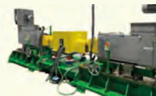
TDAS-2032P EV向けトラクションモータシステム 「E-Axle」用性能評価2軸試験ベンチ EV Motor Test Bench
