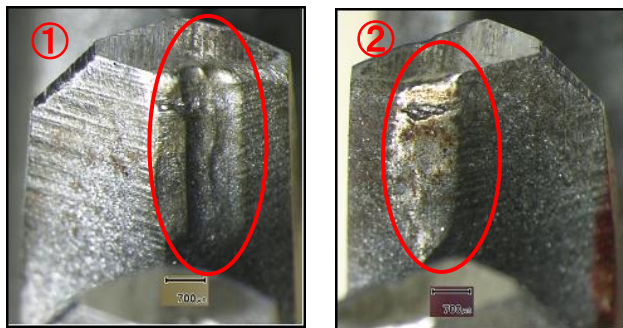
ワークと接する箇所が損傷大、使い過ぎ
