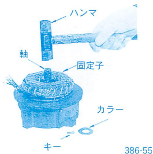
図20 軸及び連結側軸受の取り外し
